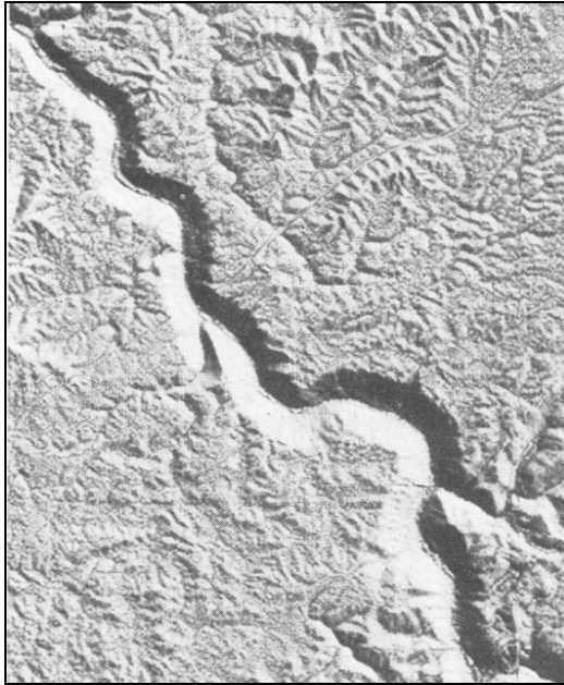
شکل ۳-۲۸) تصویر آشکارسازی شده گرادیان جهت‌دار (منبع روشنایی در گوشه بالای سمت راست قرار دارد، NE) بخشی از شکل ۳-۲۷.
